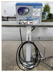
↑エアタンク型 (左)、据え置き型 (右) / タイヤのゴムキャップをはずしホースの先を押し当てるとプシューと音がして針がタイヤの空気圧を表示します。(エアタンク型)
